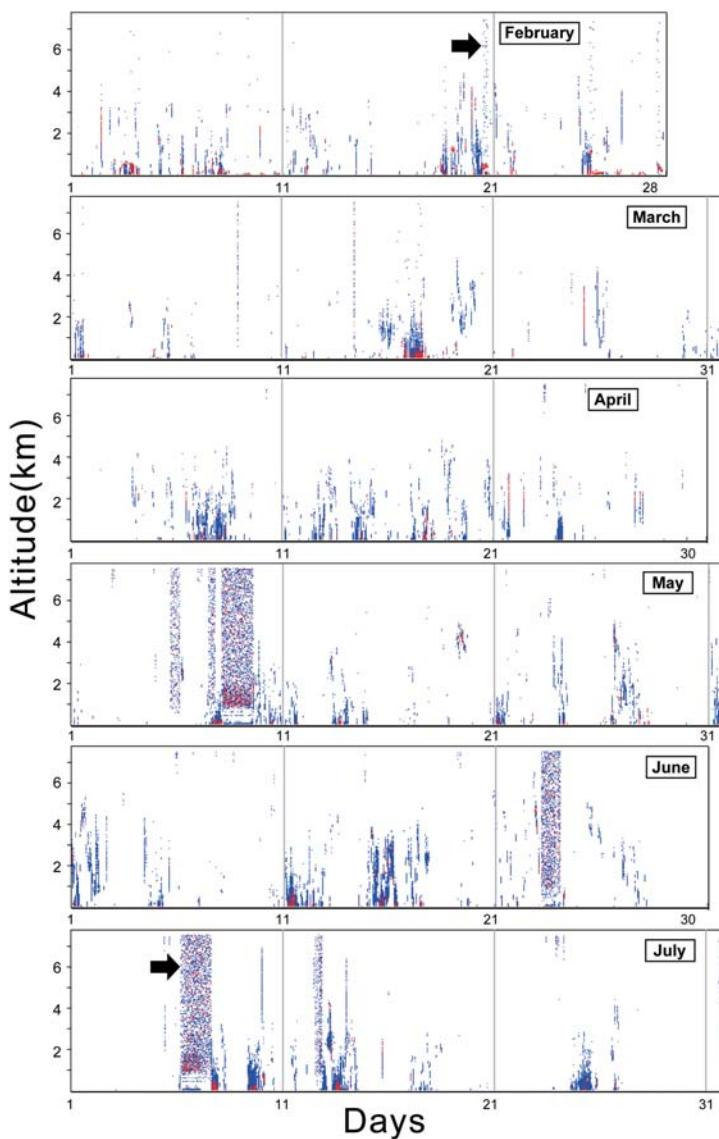
図 1 2003 年 2 月から 2004 年 1 月の月ごとの後方散乱係数の高度—時間断面。後方散乱係数が  $0.8 \cdot 10^{-5} \cdot \text{sr}^{-1} \cdot \text{m}^{-1}$  以上を赤で、 $0.25 \cdot 10^{-5} \cdot \text{sr}^{-1} \cdot \text{m}^{-1}$  以上、 $0.8 \cdot 10^{-5} \cdot \text{sr}^{-1} \cdot \text{m}^{-1}$  未満の範囲を青色で示す。矢印は 2 月 20 日 09-14 LT と 7 月 6 日 04 LT-7 月 7 日 14 LT に測定値に現れたエラー値を示す。
