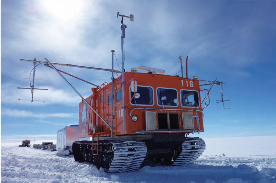
写真 1 アイスレーダー (179 MHz) を設置した雪上車 SM116. ドームふじ基地の南 5 km の地点で撮影.
