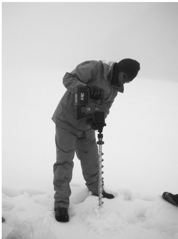
写真 3 電動ドリルによる質量収支観測用のステーク設置.
