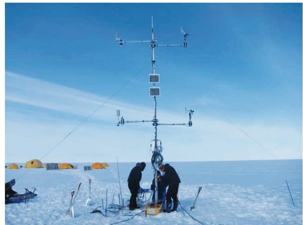
写真1. グリーンランド氷床上SIGMA-A（標高1,490m）の自動気象観測装置（2012年6月29日）
