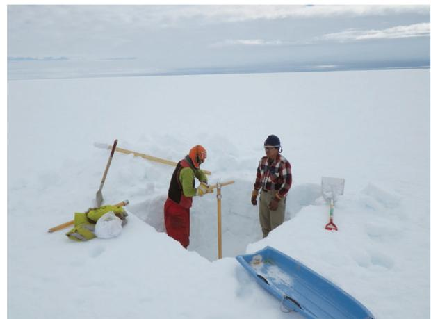
写真2. SIGMA-Aにおけるハンドオーガーによる19mのフィルンコア掘削（2012年7月3日）
