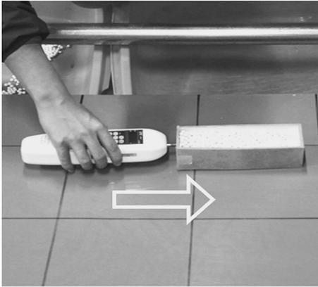
図 3 粒子の底面摩擦角  $\mu_b$  の測定.
