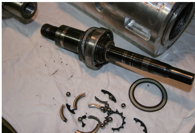
図 10 スラストベアリング破損.
